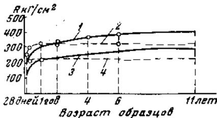
Рис. 37. График нарастания прочности бетона
